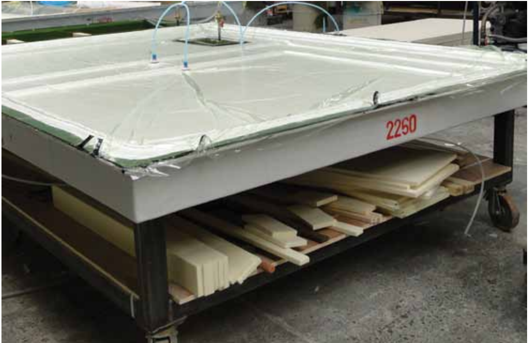
Het vacuümtrekken van de composietmal tijdens de productie van een werkstuk.
