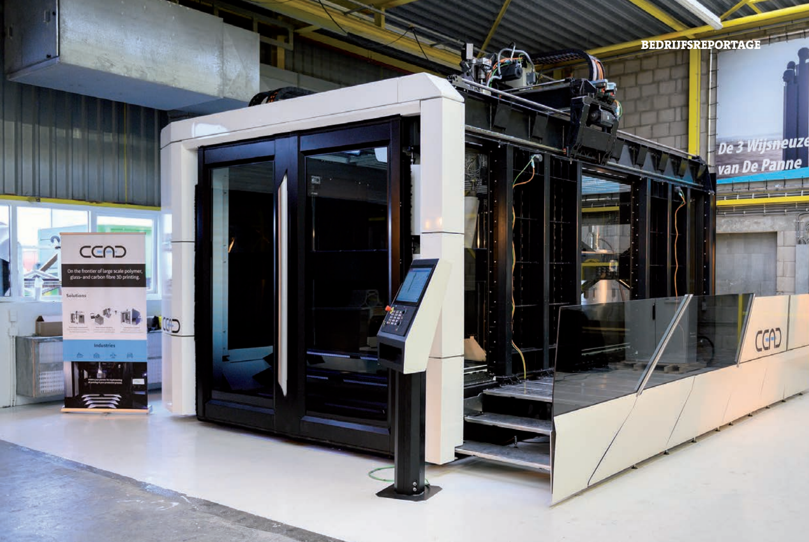
De CFAM Prime 3D-printer heeft een printoppervlak van 4 x 2 x 1,5 meter.
